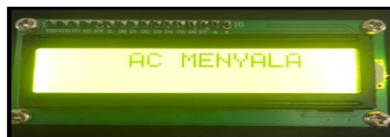
Gambar 14. Pengujian Menyalakan AC Menggunakan Voice Command Dengan Output LCD
