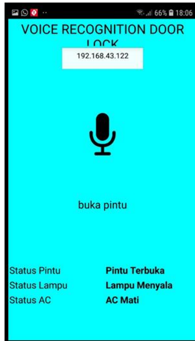
Gambar 6. Pengujian Voice Command Dengan Input Voice "Buka Pintu"
