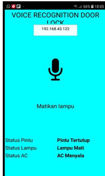
Gambar 7. Pengujian Voice Command Dengan Input Voice "Matikan Lampu"
