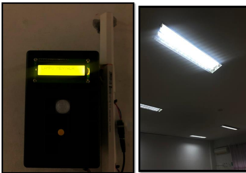
Gambar 13. Pengujian Menyalakan Lampu dan AC Menggunakan Sensor PIR
