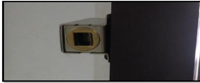
Gambar 12. Pengujian Pengaman Pintu Ruangan Menggunakan Voice "Buka Pintu" Dengan Output Solenoid Doorlock Aktif
